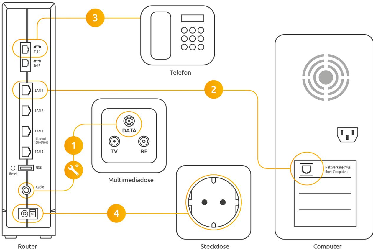
\* Die beiden F-Stecker am Antennenkabel müssen jeweils an der Multimediadose (DATA) und am Router schlüsselfest angezogen werden.
